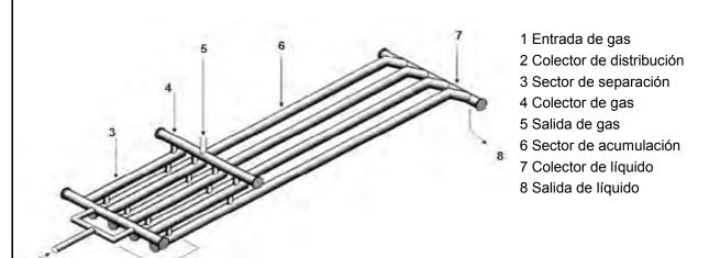
El equipo está constituido por un sector superior que se diseña considerando la separación gravitatoria y otro sector por debajo de éste que actúa como acumulador de los líquidos separados en el superior.
